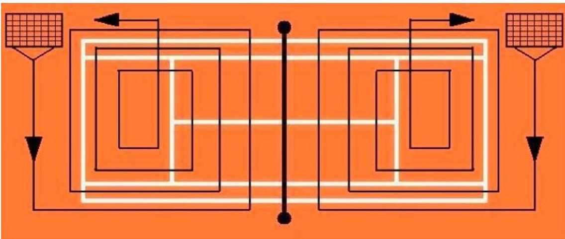
**Schritt 3:** Die Platzlinien sind mit Hilfe des Besens zu reinigen.
